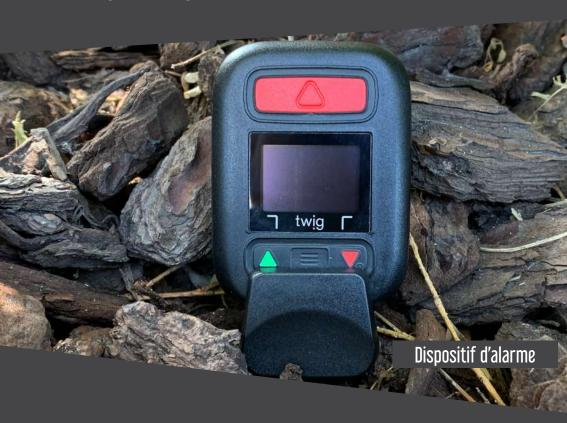
Le TWIG NEO est un dispositif d'alarme doté de fonctionnalités innovantes comme par exemple l'alarme par arrachement.
